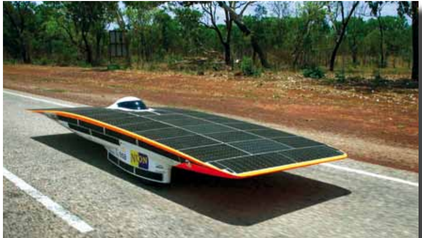
Figura 6. Coche solar Nuna 3 participando en el World Solar Challenge (velocidad media 90 km/h, 6m 2 de células solares).
