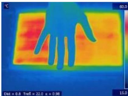
A CTAG irá desenvolver, como protótipo de demonstração, um assento aquecido. O protótipo resultante atingirá um salto térmico de 15 ° C, com o consumo inferior às resistências elétricas convencionais. **Será alimentado com uma tensão de 12V**, semelhante a uma bateria de automóvel,
