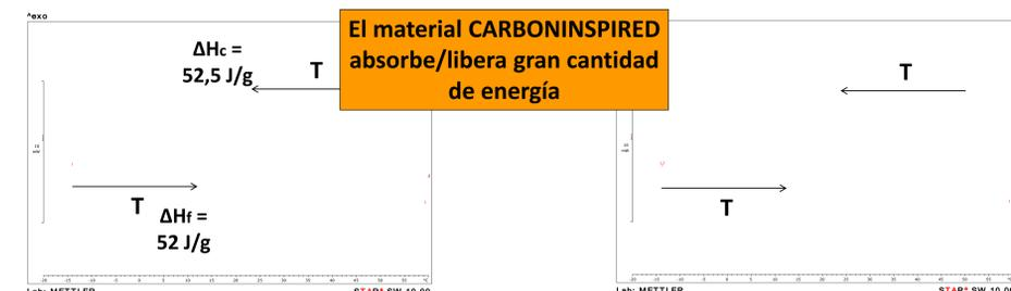
Termogramas DSC del material formado por el PCM, la resina que lo soporta y los NTCs (a) primer ciclo y (b) tras 100 ciclos
